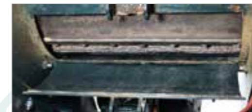
Wartungsklappe – Durch die Wartungsklappe kann das Trommelgehäuse von Fremdkörpern gereinigt werden.
