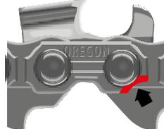
**Ursache :** Kette läuft nicht korrekt in den Schieneneinlauf hinein. Kettenrad zu klein oder zu lose Kettenspannung.
