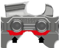
**Ursache :** Lose Kettenspannung, stumpfe Schneidezähne und Sägen mit stumpfer Kette.
