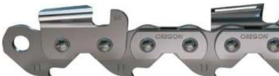
Der Semi- Chisel Schneidezahn gewährleistet eine zuverlässige und konstante Leistung. Die 3/4" Teilung und die 3,1 mm dicken Treibglieder machen die Kette widerstandsfähig und die großen Schneidezähne sägen auch das härteste Holz.
