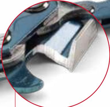
Vollmeißelschneidzähne mit neuer Form. Sauberere, schärfere, haltbarere Schneidkante. Optimierte Form des Tiefenbegrenzers. Stoßabfangende Treibglieder, geringer Rückschlag, geringere Vibration.
